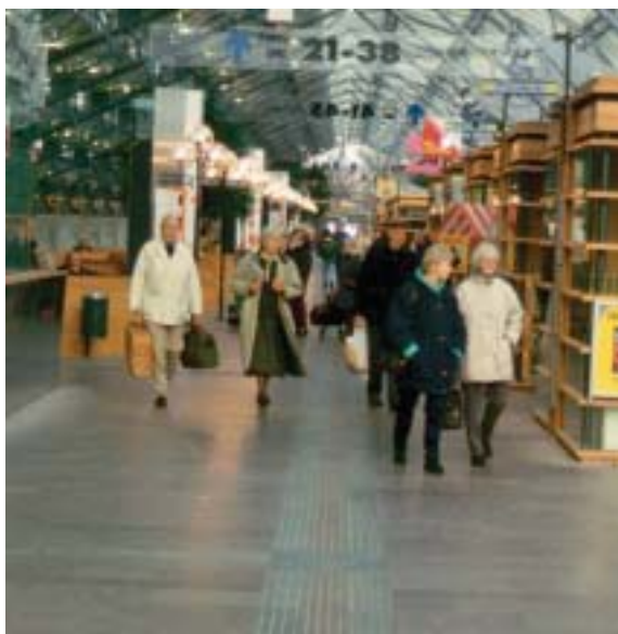
Fig 4.48 Plattor med avvikande kulör och med frästa spår inlagda för att vägleda synsvaga är samtidigt ett dekorativt inslag i miljön.
